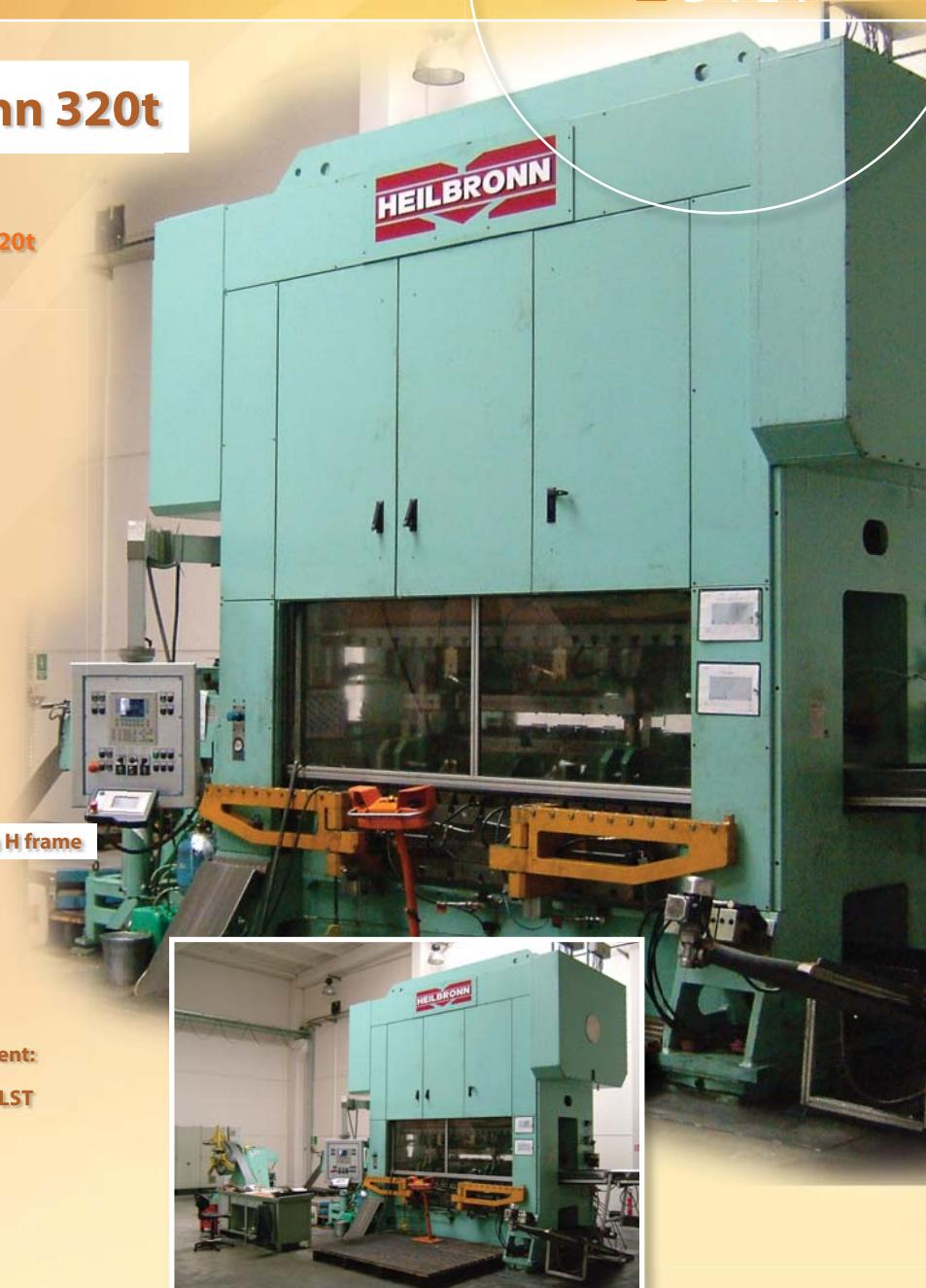
**Type de la presse: REPZ 320 S (pression jusqu'au 250 t) avec cadre H**
